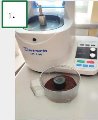
Măcinarea tescovinei la moara de laborator Retsch GM 200
