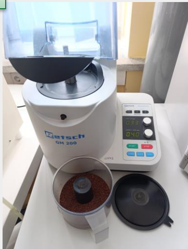
Măcinarea tescovinei la moara de laborator Retsch GM 200
