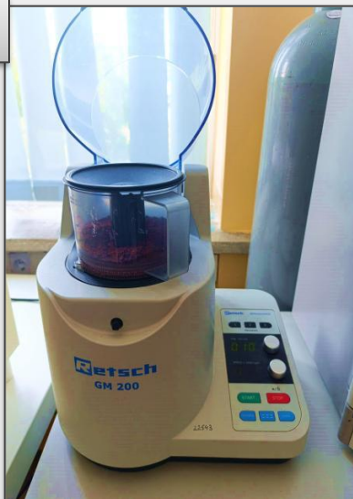
Măcinarea tescovinei la moara de laborator Retsch GM 200
